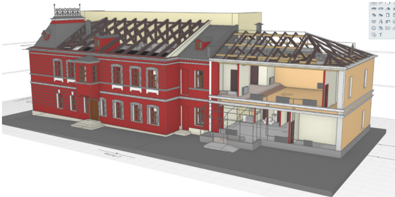
Рис. 2. ТИМ-модель реставрируемого объекта «Дом, в котором жил Чехов Антон Павлович в 1886–1890 гг. В доме – музей А. П. Чехова» [5]
