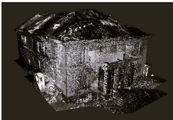
Рис. 1. Результат наземного лазерного сканирования дома для организации работ по капитальному ремонту. Материалы автора
